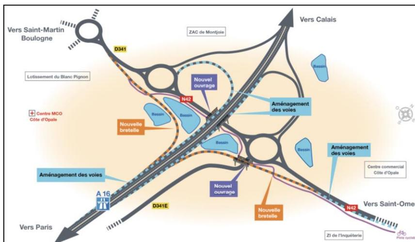
Le projet permettra d'améliorer le fonctionnement de cette zone fortement empruntée en réduisant les traversées des giratoires situés à l'est et à l'ouest de l'A16, à l'origine de remontées de files pour accueillir ces deux nouvelles bretelles.
