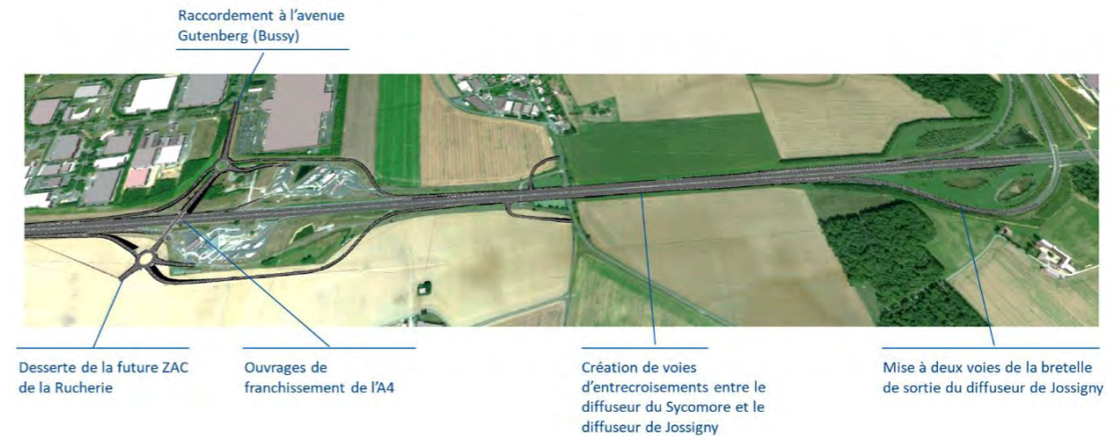
Figure 2 : Projet de diffuseur dit "Sycomore" (source : SANEF)
