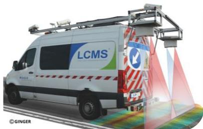
**Le LCMS** mesure la régularité de la chaussée et évalue la présence d'éventuelles fissures (et leurs profondeurs)
